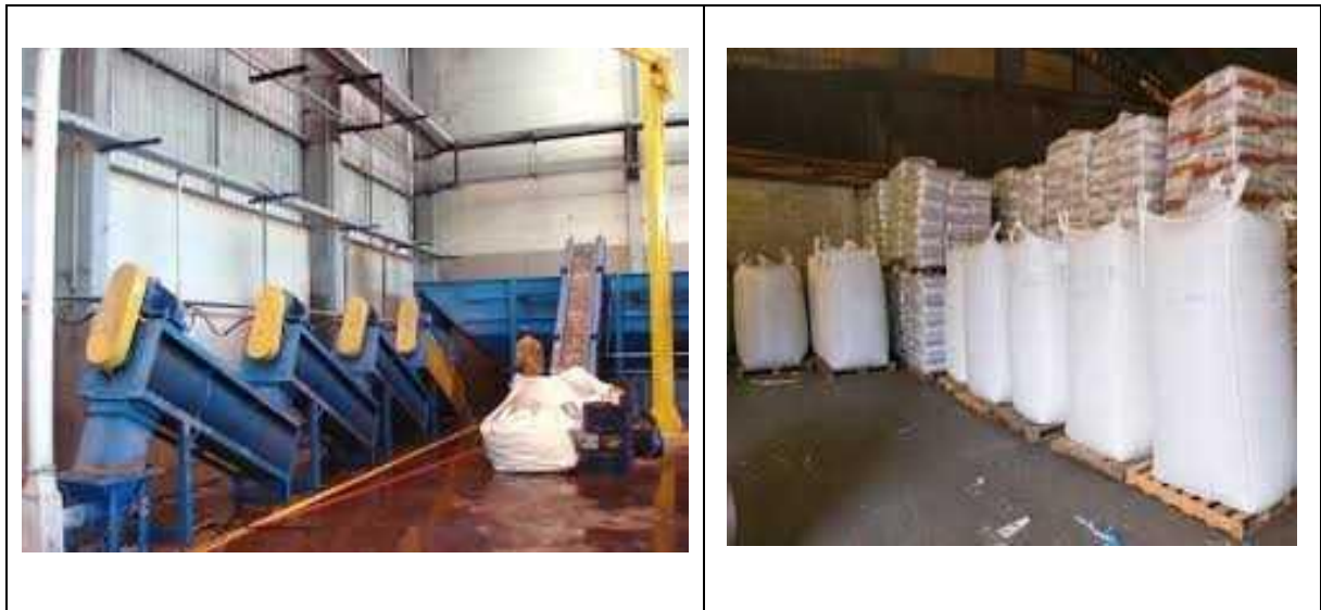
Figura 3 – Processo produtivo da empresa: trituração das carcaças de bateria
