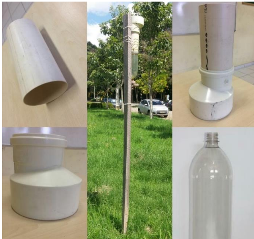
Figura 3 - Pluviômetro artesanal e local de instalação dentro do campus da UFPA.
