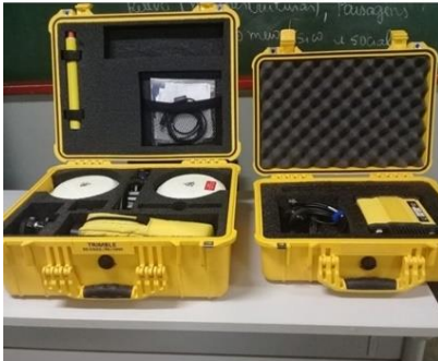
Foto 08 – GNSS Geodésico trimble R4 RTK usado pela instituição 01
