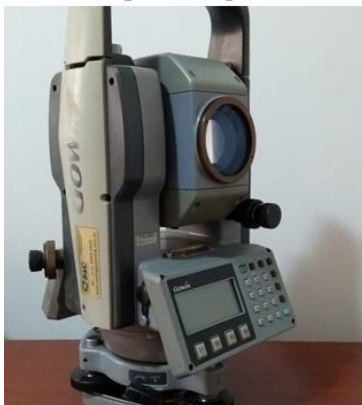
Foto 11 – Estação total usada pela empresa 03
