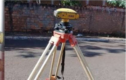
Foto 07 - GNSS Geodésico estacionado com o tripé usado pela empresa 04
