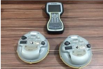
Foto 05 - Receptor GNSS L1 L2 e coletora de dados usada pela empresa 01
