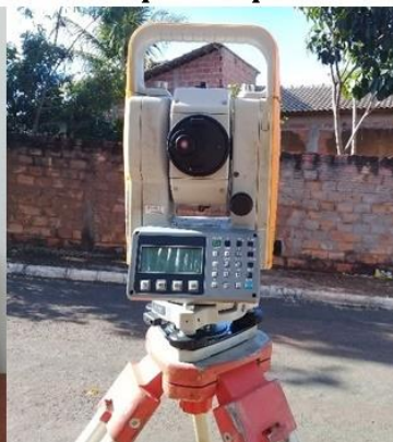
Foto 12 – Estação total estacionada com o tripé usada pela empresa 04
