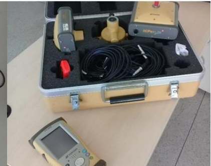
Foto 10 – GNSS Geodésico L1 L2 e coletora de dados usado pela instituição 02
