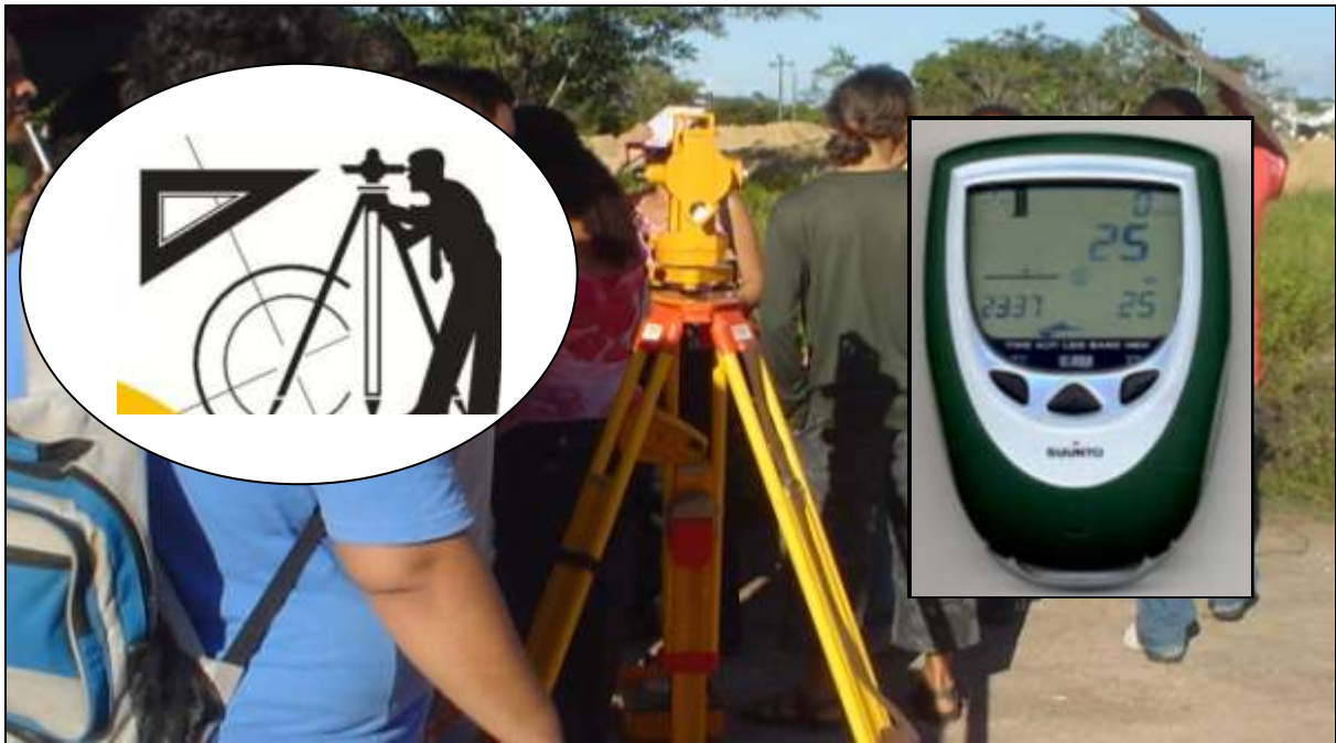
Figura 11 – Visualizador do altímetro-aneróide e taqueômetro empregados nas medidas hipsométricas
