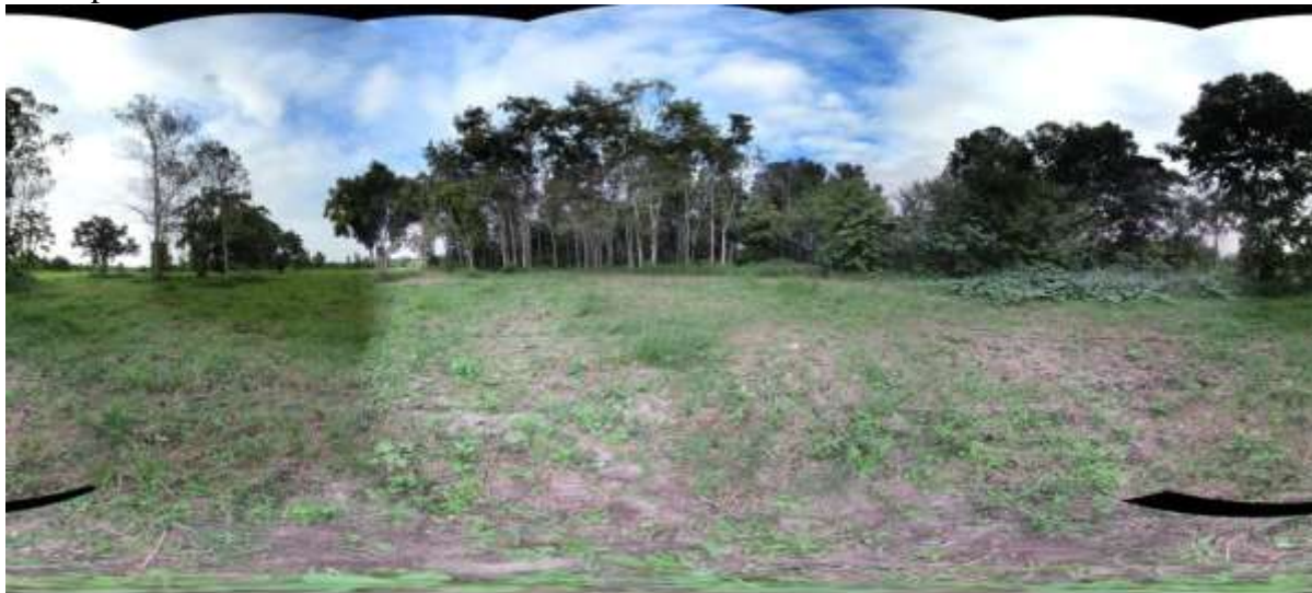
Figura 06: Imagem com variação de iluminação durante a tomada de fotos e recobrimento incompleto.
